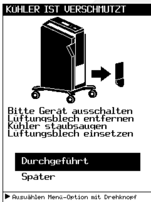
Bild 10: „Reinigung des Kühlers“
